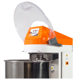
3 Sécurité : quand le couvercle est relevé, le pétrin s'arrête automatiquement.
